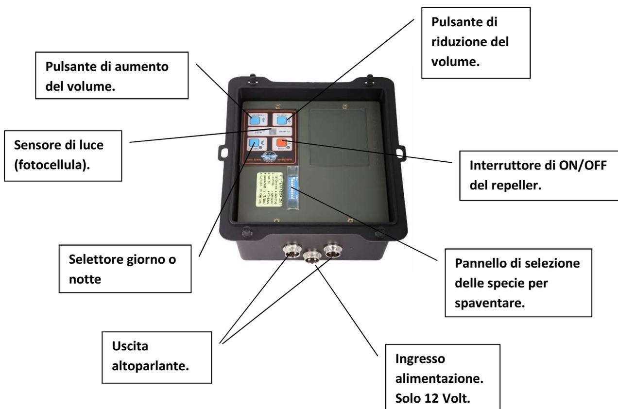
Questo repellente funziona a 12 volt con una batteria o con un 220 trasformatore da 12 V (modello AI102). Può funzionare anche con un pannello solare, che in questo caso funzionerebbe con la batteria, poiché questa fungerebbe da regolatore e accumulatore.
