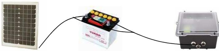
Per posizionare il dispositivo con un pannello solare, è necessario collegare i morsetti del pannello (quello rosso al positivo e quello nero al negativo) nella batteria e dalla batteria rimuovere il cavo che andrà al repeller.
